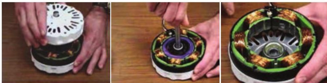
(د) شکل واقعی ماشین القایی سیم پیچ متمرکز مدل آزمایشگاهی
